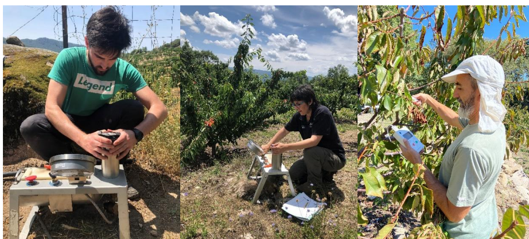
Figura 19.- Medición del potencial hídrico con cámara de presión y y conductancia estomática con el porómetro
