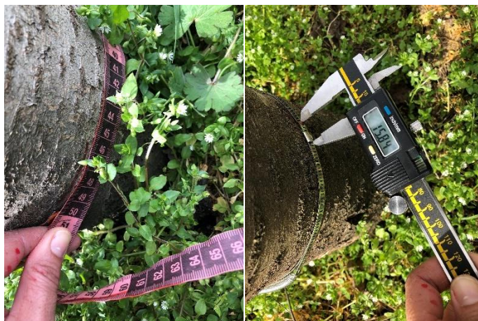
Figura 18.- Izda.) Medida de perímetro de tronco con cinta métrica flexible. Drcha.) Media del crecimiento del perímetro de tronco en dendrómetro con calibre digital.
