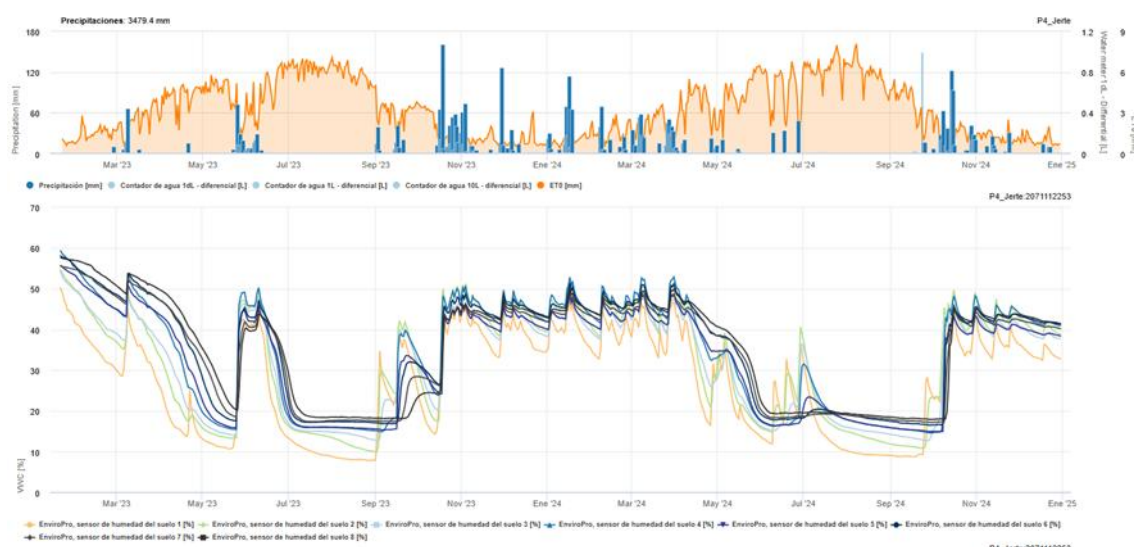
Figura 26.- Evolución de la evapotranspiración de referencia (ET o , mm) y precipitaciones (mm) en el gráfico superior, y contenido volumétrico del agua en el suelo (%) a diferentes profundidades (10, 20, 30, 40, 50, 60, 70 y 80 cm)
