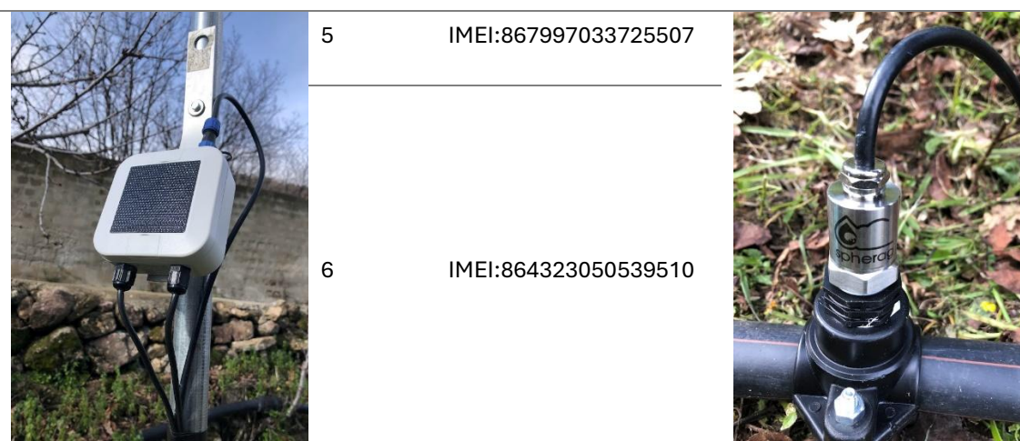
Figura 15.- Fotografía de detalle del programador atlas y el transductor de presión instalados. Referencias de los programadores.
